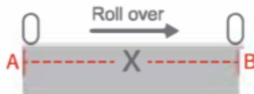
Dans le mode de mesure par défaut, Les données X représentent la distance entre le point A et le point B. Les deux extrémités de A/B sont dégagées.
